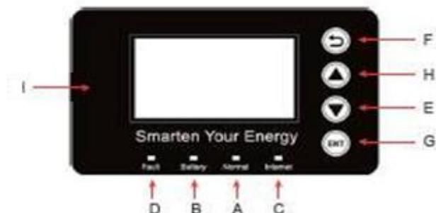
Figura 40. Schermo interfaccia inverter
