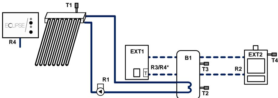
**Descrizione sintetica sistema:** il sistema gestisce il funzionamento di un campo collettori su un accumulo e di due diversi generatori di calore. E' obbligatorio cablare le sonde T1, T2, T3 e T4 ed i relè R1, R2 e R3/R4\*.
