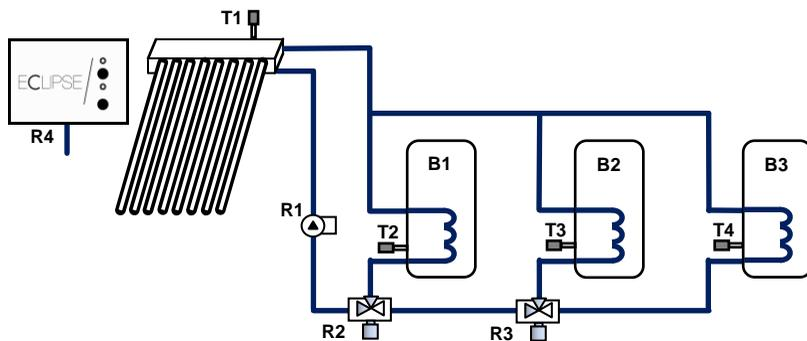
**Descrizione sintetica sistema:** il sistema gestisce il funzionamento di un campo collettori su tre accumuli, tramite pompa solare unica e doppia valvola deviatrice 3 vie. E' obbligatorio cablare le sonde T1, T2, T3 e T4 ed i relè R1, R2 e R3.
