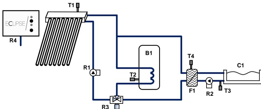
**Descrizione sintetica sistema:** il sistema gestisce il funzionamento di un campo collettori su un accumulato e su una piscina, tramite pompa solare unica, valvola deviatrice 3 vie e pompa piscina. E' obbligatorio cablare le sonde T1, T2, T3 e T4 ed i relè R1, R2 e R3.
