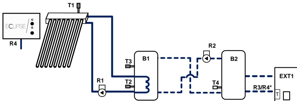
**Descrizione sintetica sistema:** il sistema gestisce il funzionamento di un campo collettori su un accumulatore e di una pompa di travaso tra due accumulatori. E' obbligatorio cablare le sonde T1, T2, T3 e T4 ed i relè R1 e R2. Opzionalmente è possibile gestire l'accensione e lo spegnimento della caldaia cablando il relè R3/R4\*.
