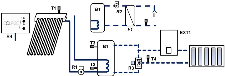
**Descrizione sintetica sistema:** il sistema gestisce il funzionamento di un campo collettori su un accumulo e di una valvola deviatrice 3 vie per l'aumento della temperatura di ritorno in caldaia. E' obbligatorio cablare le sonde T1, T2, T3 e T4 ed i relè R1 e R3. **NOTA:** questo sistema non gestisce il comando caldaia.
