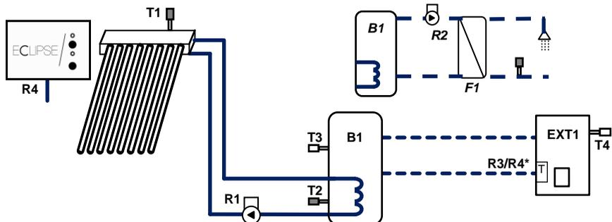
**Descrizione sintetica sistema:** il sistema gestisce il funzionamento di un campo collettori su un accumulo. E' obbligatorio cablare le sonde T1 e T2 ed il relè R1. Opzionalmente è possibile gestire:
