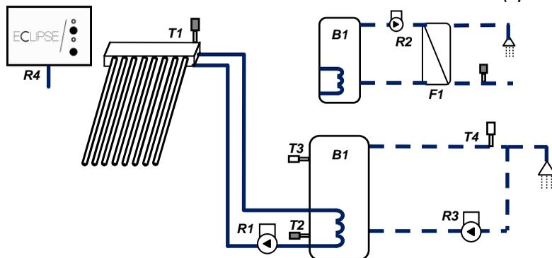
**Descrizione sintetica sistema:** il sistema gestisce il funzionamento di un campo collettori su un accumulo. E' obbligatorio cablare le sonde T1 e T2 e il relè R1. Opzionalmente è possibile gestire:
