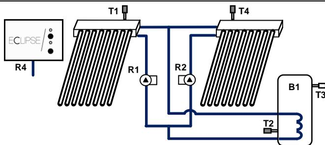
**Descrizione sintetica sistema:** il sistema gestisce il funzionamento di due campi solari (esempio est-ovest) su un accumulo tramite doppia pompa. E' obbligatorio cablare le sonde T1, T2 e T4 ed i relè R1 e R2. Opzionalmente è possibile cablare la sonda T3 per sola visualizzazione parte alta accumulo.
