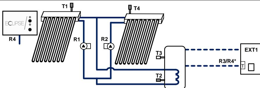
**Descrizione sintetica sistema:** il sistema gestisce il funzionamento di due campi solari (esempio est-ovest) su un accumulo tramite doppia pompa. E' obbligatorio cablare le sonde T1, T2 e T4 ed i relè R1 e R2. Opzionalmente è possibile gestire l'accensione e lo spegnimento della caldaia cablando la sonda T3 ed il relè R3/R4\*. Se T3 non è cablata (no gestione caldaia), impostare TIPO T3=N.C. nel menu SET SENSORI.
