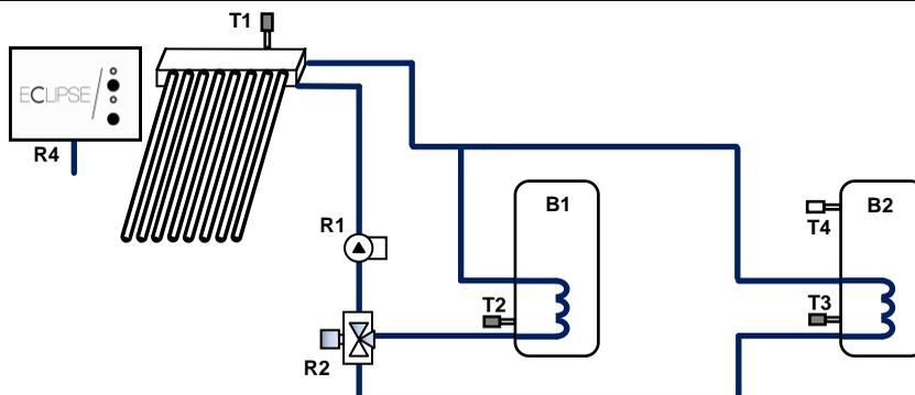
**Descrizione sintetica sistema:** il sistema gestisce il funzionamento di un campo collettori con valvola deviatrice 3 vie su due accumuli. E' obbligatorio cablare le sonde T1, T2 e T3 ed i relè R1 e R2. Opzionalmente è possibile cablare la sonda T4 per sola visualizzazione parte alta accumulo.
