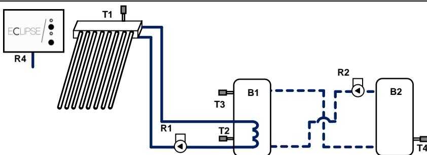
**Descrizione sintetica sistema:** il sistema gestisce il funzionamento di un campo collettori su un accumulatore e di una pompa di travaso tra due accumulatori. E' obbligatorio cablare le sonde T1, T2, T3 e T4 ed i relè R1 e R2.
