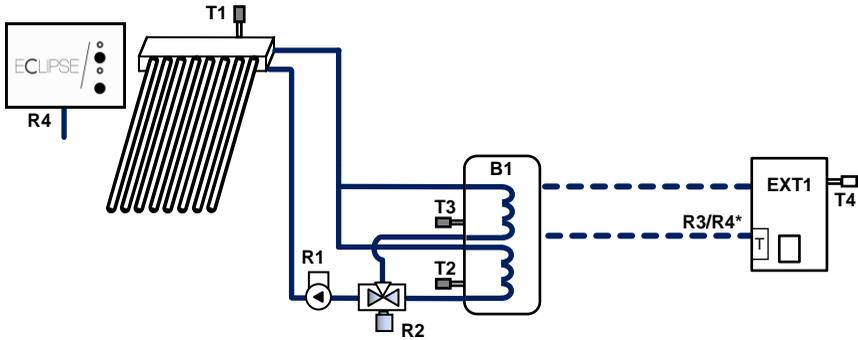
**Descrizione sintetica sistema:** il sistema gestisce il funzionamento di un campo collettori con valvola stratificatrice e accumulo, con caricamento prioritario parte alta, secondario parte bassa. E' obbligatorio cablare le sonde T1, T2 e T3 ed i relè R1 e R2. Opzionalmente è possibile gestire l'accensione e lo spegnimento della caldaia cablando la sonda T3 ed il relè R3/R4\*.
