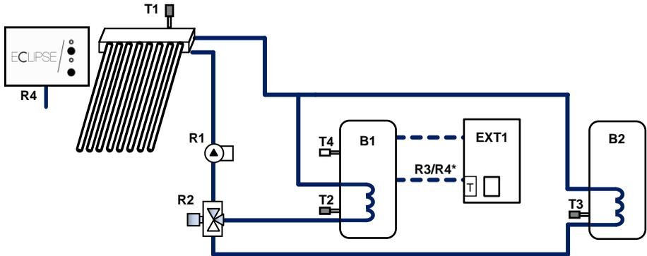
**Descrizione sintetica sistema:** il sistema gestisce il funzionamento di un campo collettori con valvola deviatrice 3 vie su due accumuli. La priorità è assegnata, di default, all'accumulo B1. E' obbligatorio cablare le sonde T1, T2 e T3 ed i relè R1 e R2. Opzionalmente è possibile gestire l'accensione e lo spegnimento della caldaia cablando la sonda T4 ed il relè R3/R4\*. Se T4 non è cablata (no gestione caldaia), impostare TIPO T4=N.C. nel menu SET SENSORI.
