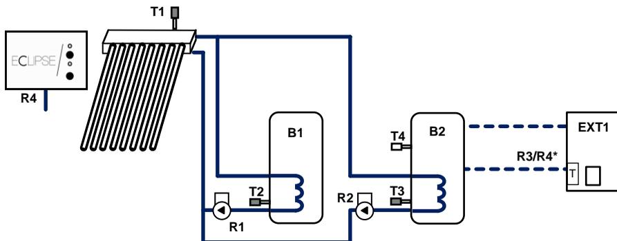
**Descrizione sintetica sistema:** il sistema gestisce il funzionamento di un campo collettori su due accumuli tramite doppia pompa. E' obbligatorio cablare le sonde T1, T2 e T3 ed i relè R1 e R2. Opzionalmente è possibile gestire l'accensione e lo spegnimento della caldaia cablando la sonda T4 ed il relè R3/R4\*.
