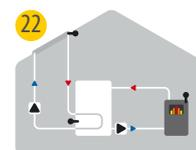
22 Solare con caldaia a legna
