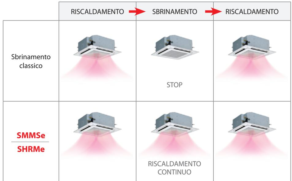
La gamma eLine, grazie al riscaldamento continuo a retroazione totale, tiene costantemente monitorato lo stato della batteria dell'unità esterna.
