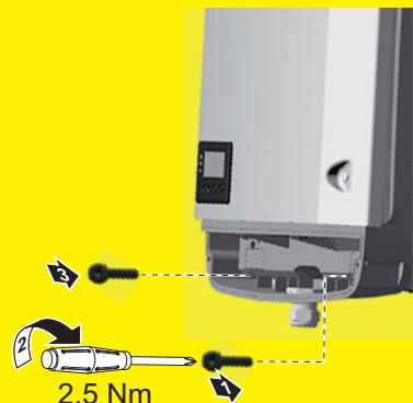
Zet de inverter met behulp van bevestigingsschroeven altijd stevig vast aan de muursteun. Houd u hierbij aan het aanhaalmoment dat in de gebruiksaanwijzing is aangegeven.
