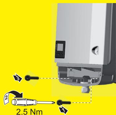
Vissez toujours l'onduleur au support mural à l'aide des vis de fixation en respectant le couple de serrage figurant dans les Instructions de service.
