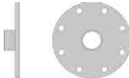
A richiesta viene fornita la flangia apposita per l'installazione della resistenza
