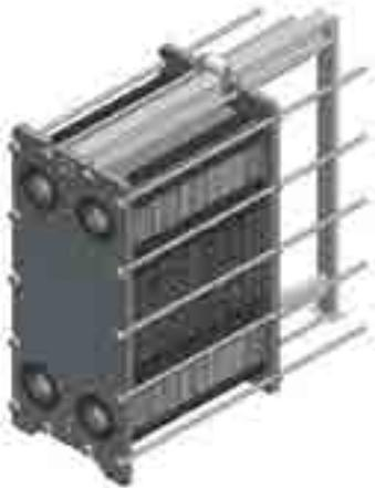
Negli scambiatori a piastre ispezionabili l'accostamento di più piastre forma il pacco piastre; all'interno si creano i canali di scorrimento dei fluidi, alternati ed in controcorrente, che lambiscono in senso inverso le facce opposte di ciascuna piastra.
