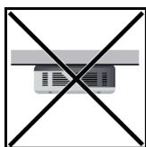
Non montare Fronius Ohmpilot sul soffitto.
