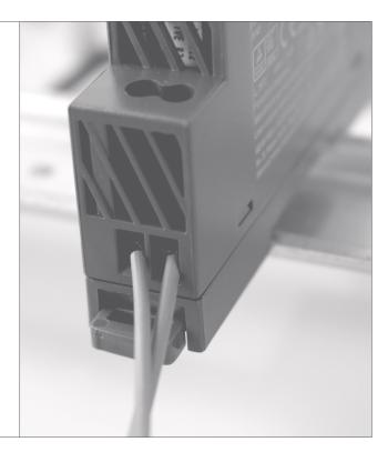
Collegare il cavo micro-USB dell'alimentatore alla port micro-USB dello SNOCU DIN Version.
