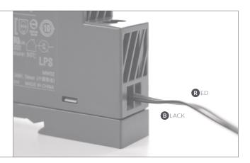
Fissare l'alimentatore alla barra DIN da 35 millimetri.
