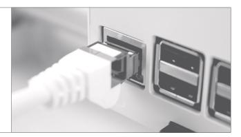
Collegare il connettore RJ45 del cavo Ethernet a una porta Ethernet dello switch o del router dove vi sia attiva sia una connessione ad Internet che un server DHCP per l'assegnazione dinamica degli indirizzi di rete.
