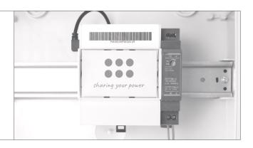
Collegare il connettore RJ45 del cavo Ethernet alla porta Ethernet dello SNOCU DIN Version.
