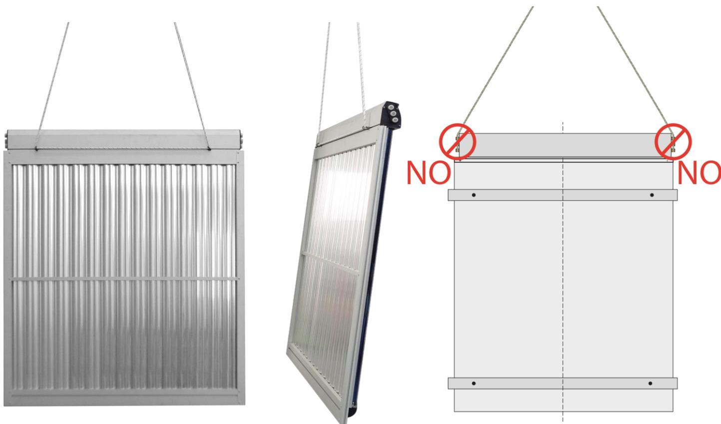
Non sollevare il collettore utilizzando gli attacchi idraulici filettati, non sollevare il collettore gravando o tirando sui tubi di vetro. Evitare che il collettore subisca colpi o azioni meccaniche, proteggete soprattutto i tubi in vetro che per la loro natura sono particolarmente fragili.
