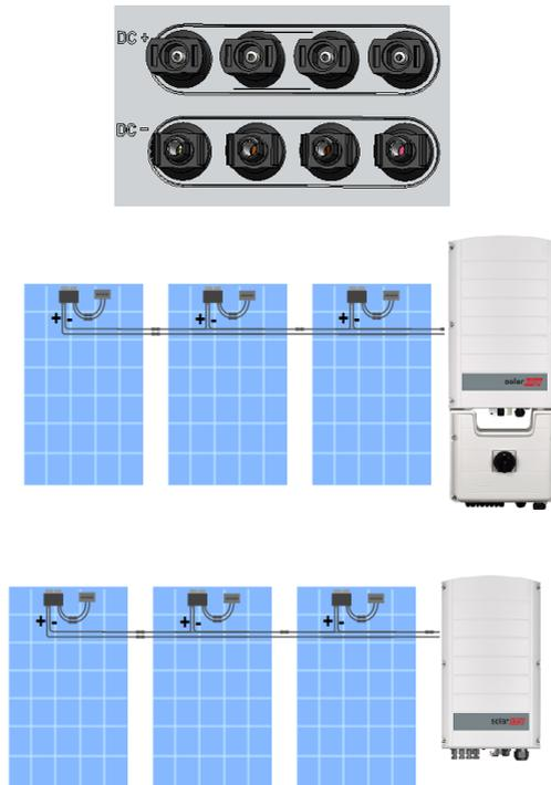
Figura 20: Connettori MC4 CC Inverter/Unità di sicurezza CC
