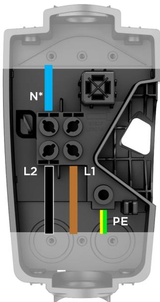
\* Quando si effettua un collegamento Delta da 230 V senza rete elettrica Neutro, far terminare uno dei collegamenti di Fase nel terminale di Neutro della scatola dei cavi.
