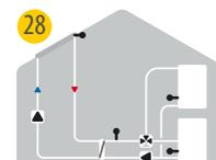
28 Solare con scambiatore e 2 accumulatori
