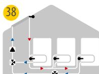
38 Solare con 3 accumulatori e 2 valvole
