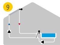
9 Solare con scambiatore calore (sonda sul secondario) e piscina
