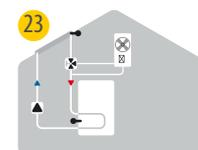
23 Solare con raffreddamento 1 (raffreddamento collettore)
