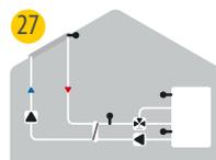
27 Solare con scambiatore e valvola di zona
