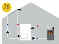
26 Solare con accumulatore e caldaia a legna
