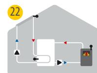
22 Solare con caldaia a legna
