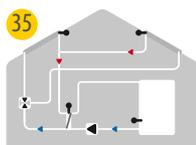
35 2x Solare con accumulatore, scambiatore e valvola
