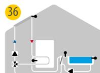
36 Solare con piscina, accumulatore, scambiatore e valvola
