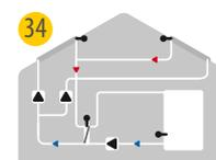
34 2x Solare con accumulatore, scambiatore e 3 pompe
